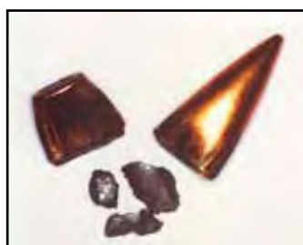
Figura IV.17 Bala encamisada rota exponiendo su contenido de plomo
