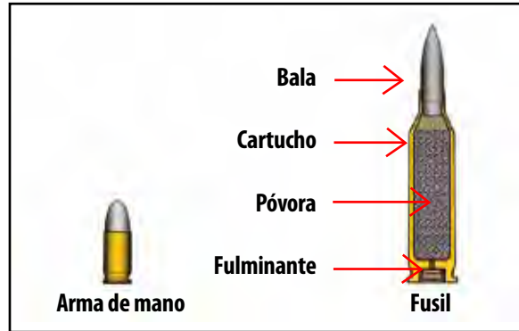
Figura IV.5 Composición de las balas de rifle
