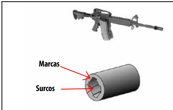
Figura IV.10 Corte transversal del cañón de un arma: 5,56 x 45 mm M-16 A4 rifle de asalto militar. Se observan los surcos y las marcas (los tramos elevados entre las ranuras).
